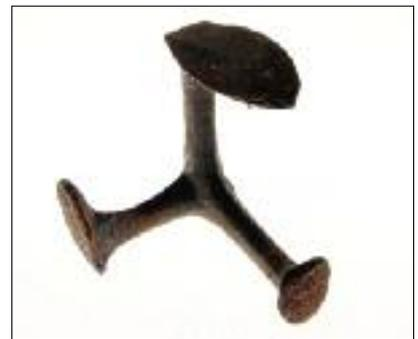
Drehfu-et = Dreifuß (Gusseisen) zum Besohlen von Schuhen
